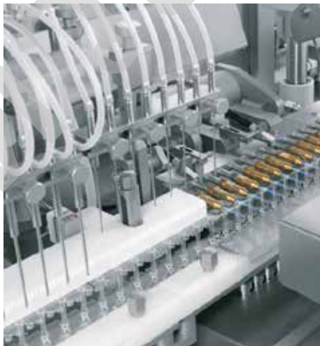
รูปที่ 1.5 เครื่องบรรจุและปิดผนึกที่ใช้ในโรงงานอุตสาหกรรมการผลิตยาฉีด (จากเอกสารอ้างอิง 19)
